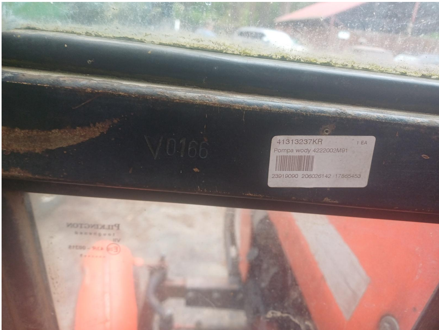
9.3. Numery fabryczne ciągnika uwidocznione na moście tylnym w części górnej środkowej.
